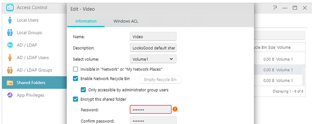
**提醒：**当您选择将共享文件夹加密后，请妥善保存您的密码。倘若密码遗失，该文件夹中的数据将永远遗失且无法以任何方式找回。
