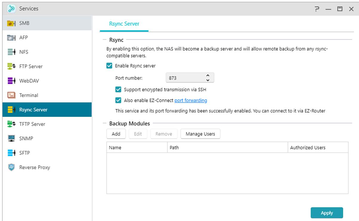
如果要允许客户端以加密方式进行备份，请启用支持透过 SSH 的加密传输。若您启用加密传输，系统将自行开启**终端机**内之 SSH 服务。
