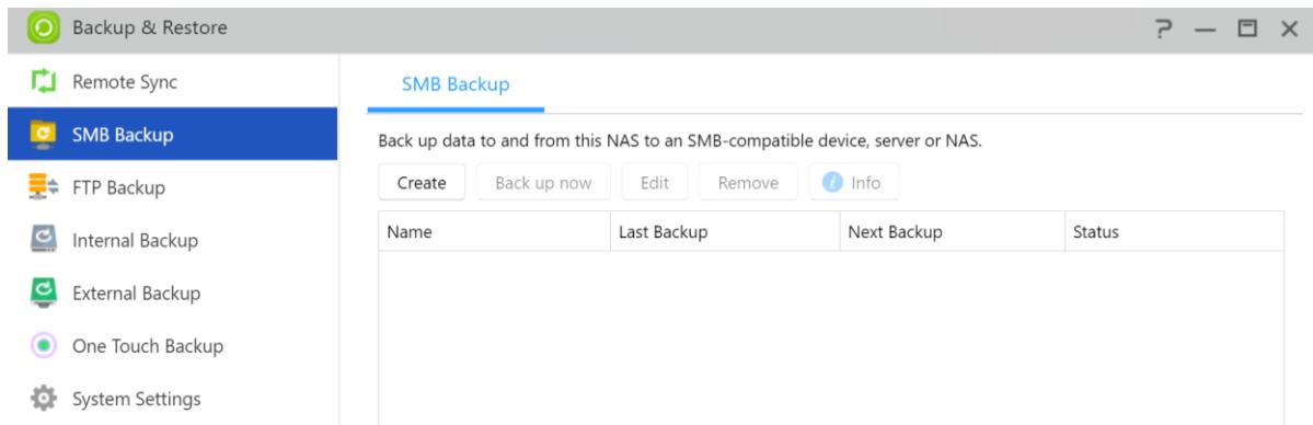
使用 SMB 备份时，请确保在来源和目的装置上启用 SMB 服务。（请参阅 [服务] [SMB]）
