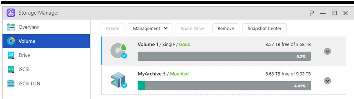
硬盘群组（储存空间）是由一个或数个硬盘所组合而成的逻辑扇区（Logical Volume）。您可在此建立新的储存空间，根据对于数据保护的需求，来选择最适合此储存空间的 RAID 等级。您仅可以以内接硬盘来建立储存空间，为确保数据完整性，ADM 并不支持以外接硬盘来建立储存空间。
