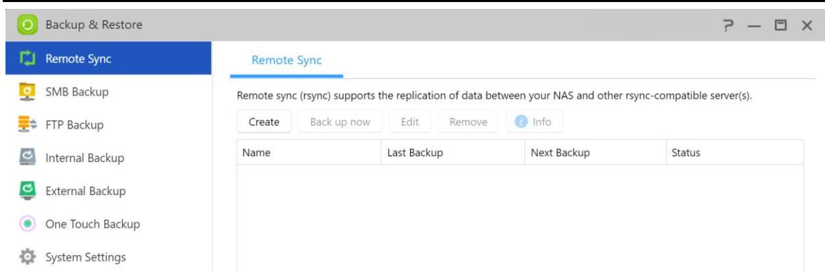
远程同步(Rsync)可支持多向备份模式。您可将本机 NAS 的数据主动备份至另一台远程的 ASUSTOR NAS 或 Rsync 兼容服务器，达到异地支援的效果。亦可由远程的 ASUSTOR NAS 或 Rsync 兼容服务器，将数据抓回本机 NAS 存放，让本机 NAS 成为数据备份中心。
