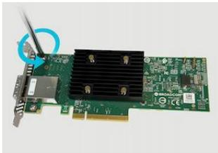
4. Прикрепите плату расширения к предустановленному кронштейну PCIe Gen5 x8 и закрепите ее винтами в направлении, указанном стрелкой.
