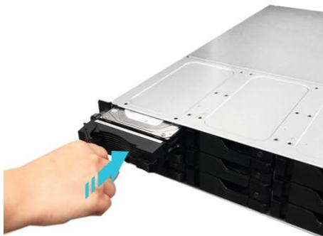
5. Закрепленную защелку можно заблокировать фиксатором лотка для дисков. Возьмите отвертку с плоской головкой и поверните фиксатор против часовой стрелки, чтобы заблокировать механизм защелки. Чтобы разблокировать механизм, поверните фиксатор по часовой стрелке.
