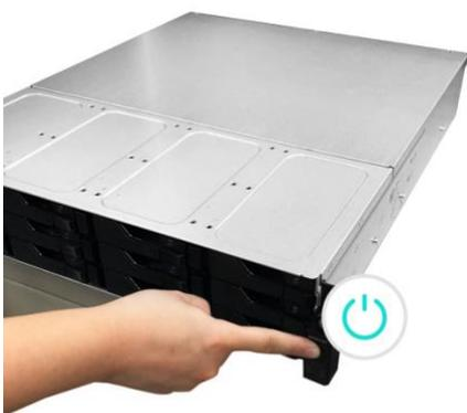
4. Устройство NAS готово к работе после того, как зеленый индикатор состояния системы перестает мигать и горит постоянно. В этот момент подается звуковой сигнал зуммера системы. После этого установка оборудования будет завершена. Теперь для настройки системы обратитесь к руководству по установке программного обеспечения.
