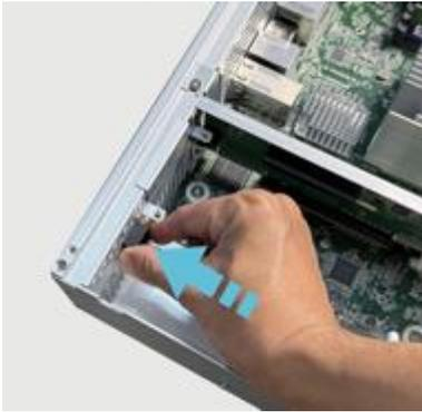
2. Открутите винт, фиксирующий кронштейн.
