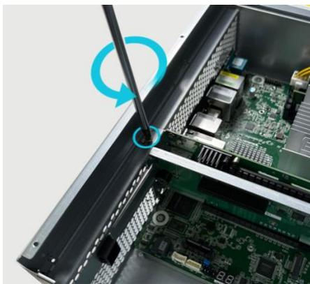
➤ Действия по использованию слота расширения PCIe Gen5 x8:
