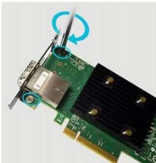
5. Установите плату расширения в устройство и закройте крышку кронштейна.
