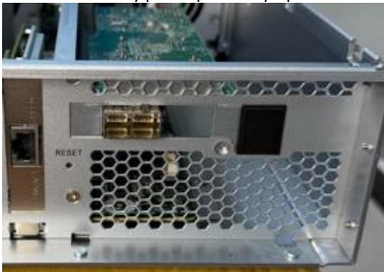
Обратите внимание: для правильной установки кронштейн, предварительно установленный в слот PCIe Gen5 x8, должен соответствовать стандартным спецификациям монтажных отверстий PCIe, как показано на рисунке.
