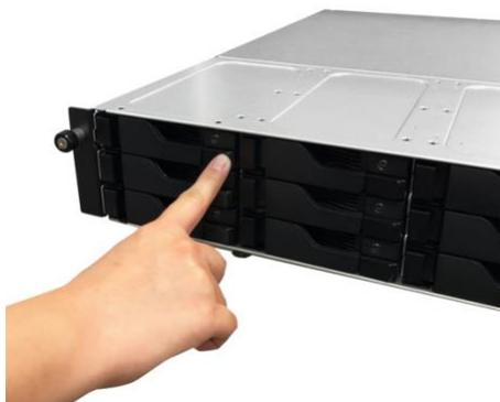
2. Usando a trava, puxe suavemente a bandeja de disco para fora do compartimento de disco.
