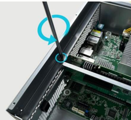
➤ Etapas para usar o slot de expansão PCIe Gen5 x8::
