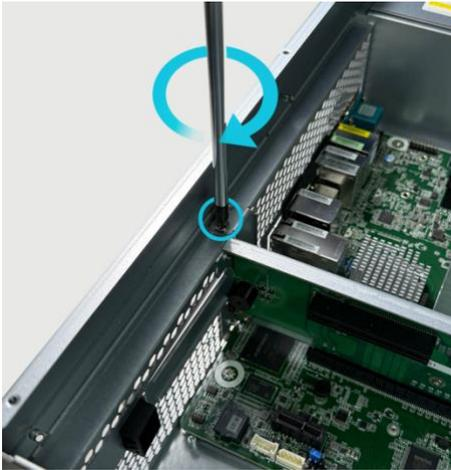
2. Ao inserir uma placa de expansão PCIe x4, certifique-se de que o conector inferior da placa esteja alinhado corretamente com o slot. Empurre a placa suavemente no lugar usando dois dedos.
