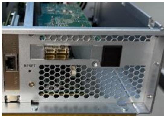
Observação: O suporte pré-instalado no slot PCIe Gen5 x8 deve corresponder às especificações padrão do orifício de montagem PCIe para ser instalado corretamente, como mostra a figura.
