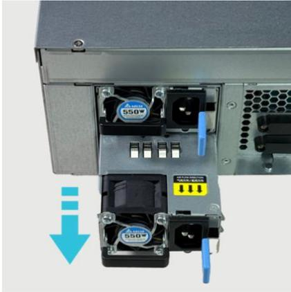
4. Prepare uma nova PSU e empurre-a de volta para o slot até ouvir um clique.
