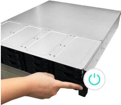
4. 시스템 상태 LED 표시등이 깜박거림을 멈추고 계속 켜진 상태로 바뀌면 이제 NAS 를 사용할 수 있습니다. 이 때, 시스템에서 '비프음'이 울립니다. 이제 하드웨어 설치가 완료되었습니다. 소프트웨어 설치 방법으로 넘어가서 시스템 설정을 구성하십시오.
