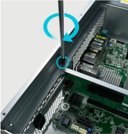
2. PCIe x4 확장 카드를 삽입할 때, 카드의 하단 커넥터가 슬롯과 정확히 맞추어져 있는지 확인하십시오. 두 손가락으로 카드를 부드럽게 밀어 넣어 고정하십시오.
