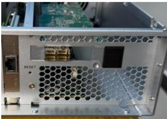
참고: PCIe Gen5 x8 슬롯에 사전 설치된 브래킷은 그림에 표시된 대로 표준 PCIe 마운팅 홀 사양과 일치해야 정상적으로 설치될 수 있습니다.
