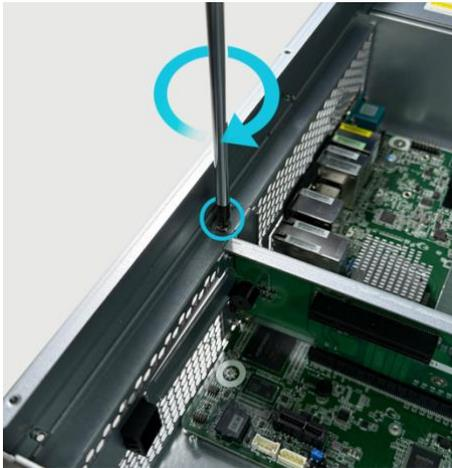
2. Durante l'inserimento di una scheda di espansione PCIe x4, assicurarsi che il connettore inferiore della scheda sia correttamente allineato con lo slot. Spingere delicatamente la scheda in posizione utilizzando due dita.
