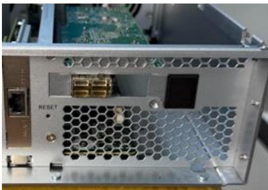
Si prega di notare: il supporto preinstallato nello slot PCIe Gen5 x8 deve corrispondere alle specifiche standard dei fori di montaggio PCIe per essere installato correttamente, come mostrato nella figura.
