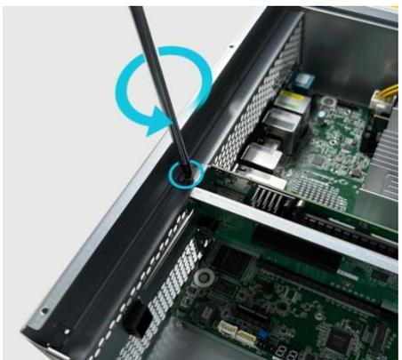
➤ Procedura per l'utilizzo dello slot di espansione PCIe Gen5 x8
