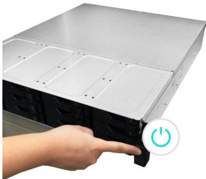
4. Il NAS è pronto all'uso quando il LED verde dello stato del sistema smette di lampeggiare e rimane acceso. A questo punto dovrebbe anche sentirsi un 'bip' dal cicalino del sistema. L'installazione dell'hardware è così completa. Passare quindi alla guida per l'installazione del software per configurare le impostazioni di sistema.
