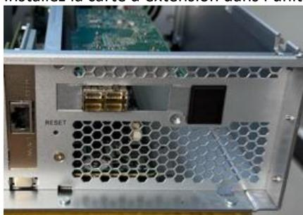
Remarque : le support préinstallé dans l'emplacement PCIe Gen5 x8 doit correspondre aux spécifications du trou de montage PCIe standard pour être installé correctement, comme indiqué sur la figure
