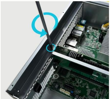
➤ Étapes d'utilisation de l'emplacement d'extension PCIe Gen5 x8 :
