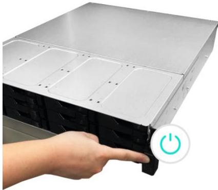
4. Le NAS est prêt à fonctionner une fois que le voyant LED vert d'état du système cesse de clignoter et reste allumé. À ce moment, vous devriez aussi entendre un 'bip' au niveau du buzzer du système. L'installation du matériel est maintenant terminée. Veuillez aller dans le guide d'installation du logiciel pour configurer les paramètres de votre système.
