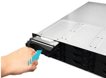
5. Sobald der Riegel befestigt ist, können Sie ihn mit Hilfe der Sperre des Datenträgerfachs verriegeln. Drehen Sie die Sperre zum Verriegeln des Mechanismus mit einem Schlitzschraubendreher gegen den Uhrzeigersinn. Durch Drehen im Uhrzeigersinn entriegeln Sie die Sperre.
