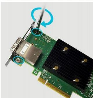
5. Die Karte in das Gerät einsetzen und die Blendenabdeckung wieder anbringen.
