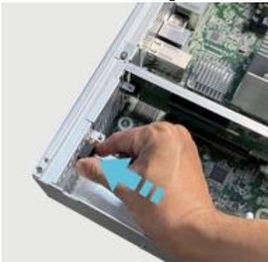
2. Die Schraube lösen, mit der die Blende befestigt ist.
