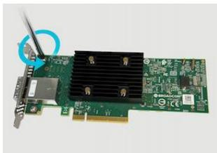
4. Die Erweiterungskarte an der zuvor entnommenen PCIe-Gen5-x8-Blende befestigen und mit den Schrauben in Pfeilrichtung sichern.
