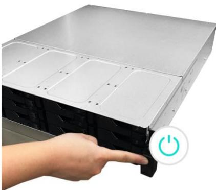
4. Der NAS ist betriebsbereit, sobald die grüne Systemstatus-LED nicht mehr blinkt, sondern dauerhaft leuchtet. Dabei sollten Sie einen Signalton hören. Die Hardwareinstallation ist nun abgeschlossen. Lesen Sie zur Konfiguration der Systemeinstellungen nun die Softwareinstallationsanleitung.
