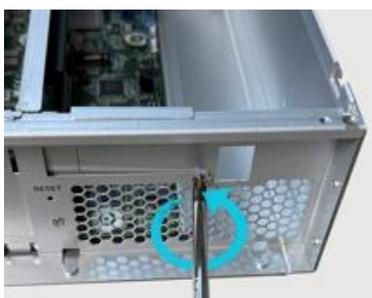
2. Mit dem Daumen durch die Aussparung drücken und die Schrauben in Pfeilrichtung lösen.
