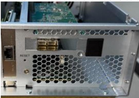
Hinweis: Die im PCIe-Gen5-x8-Steckplatz vorinstallierte Blende muss den Standard-PCIe-Montagebohrungen entsprechen, damit sie korrekt eingesetzt werden kann (siehe Abbildung).
