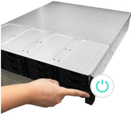
4. 当您看到绿色系统指示灯恒亮并听到一声“哔”时，表示 NAS 系统已就绪。至此系统开机程序已完成，请参阅软件安装指南进行系统设定。
