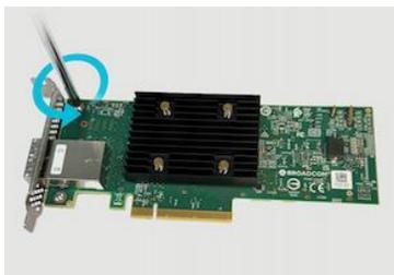
依下图所示，将扩充卡与预载在 PCIe Gen5 x8 插槽上的挡板，依箭头方向安装螺丝。
