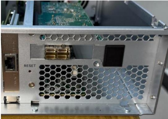
请注意预载在 PCIe Gen5 x8 插槽上的槽板，扩充卡需要符合标准 PCIe 规格的孔位，才能正常的安装，如下图所示。
