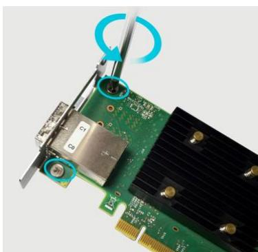
依下图所示，将扩充卡安装在机台上并固定槽板的盖子。
