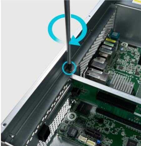
2. 如下图所示，插入 PCIe x4 扩充卡时，确认扩充卡底部接头与插槽连接，两指轻推扩充卡至固定位置。
