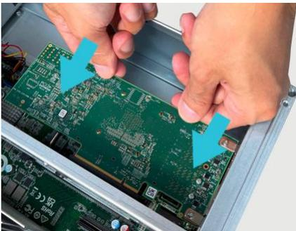
4. 如下图所示，将固定槽板的盖子，依前头方向装回。
