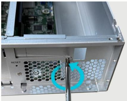
如下图所示，依箭头方向拆下内折挡板和螺丝。
