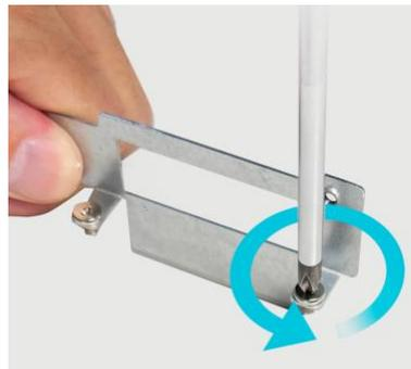
依下图所示，将扩充卡上的挡板，依箭头方向拆下螺丝。
