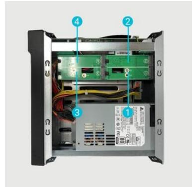
2. M.2 SSD 를 장착하고 노치를 커넥터에 맞춘 다음 M.2 드라이브를 삽입합니다. M.2 SSD 가 완전히 장착되었는지 확인하고 플라스틱 레버를 잡고 슬롯에 클립이 끼워질 때까지 M.2 SSD 를 누릅니다.
