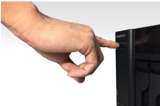
4. 시스템 상태 LED 표시등이 깜박거림을 멈추고 계속 켜진 상태로 바뀌면 이제 NAS 를 사용할 수 있습니다. 이 때, 시스템에서 '비프음'이 울립니다. 이제 하드웨어 설치가 완료되었습니다. 소프트웨어 설치 방법으로 넘어가서 시스템 설정을 구성하십시오.
