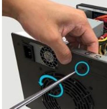
6. AS-T10G2 NIC 에서 full-height 브래킷을 풀고 제거합니다. [AS-T10G2](#) 를 설치하려면 NAS 장치의 Lockerstor Gen2 시리즈용으로 설계된 브래킷을 사용해야 합니다.
