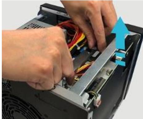
5. NAS からプレースホルダーブラケットの背面にある両方のネジを外します。
