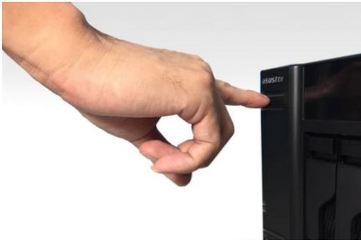
4. 緑のシステムステータス LED インジケータが点滅を停止ししっかりと点灯すると、NAS を操作する準備ができました。このとき、システムブザーから「ピープ」音も聞こえます。ハードウェアの取り付けはこれで完了です。ソフトウェアのインストールガイドに移ってシステム設定を構成してください。
