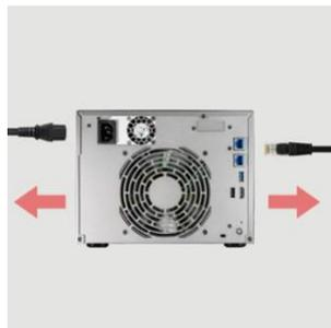
NAS 内部の PCIe ソケットはホットスワップ機能をサポートしていません。PCIe デバイスを変更する前に、一度 NAS をシャットダウンしてからプラグを抜いてください。
