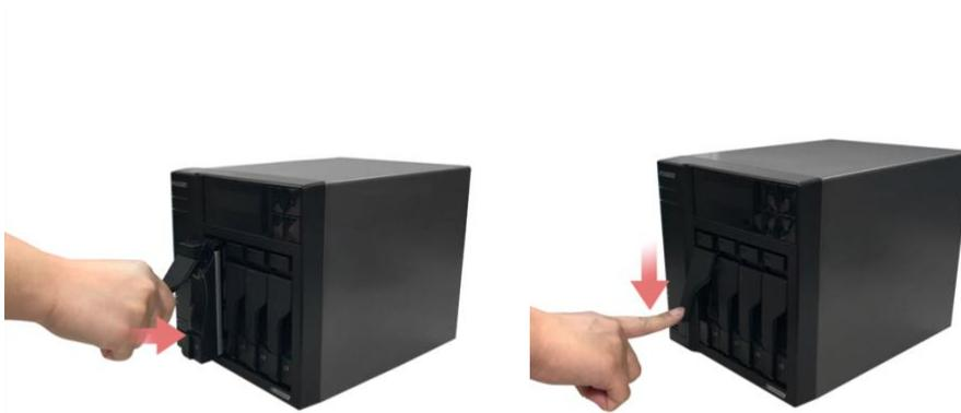
5. ラッチを閉めたら、ディスクトレイロックでしっかりと固定してください。平らなドライバーで、反時計回りにまわしてラッチを固定します。時計回りにまわすとロックを緩められます。
