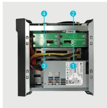
2. M.2 SSDを斜めに挿入し、切り欠きをコネクタに合わせ、M.2SSDを最後まで挿入します。M.2 SSDが完全に挿入されていることを確認し、プラスチック製のレバーを持ち、スロットにカッチリとハマるまでM.2 SSDを押し倒します。
