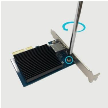
7. NAS 専用ブラケットを AS-T10G2 に取り付け、ネジで固定します。
