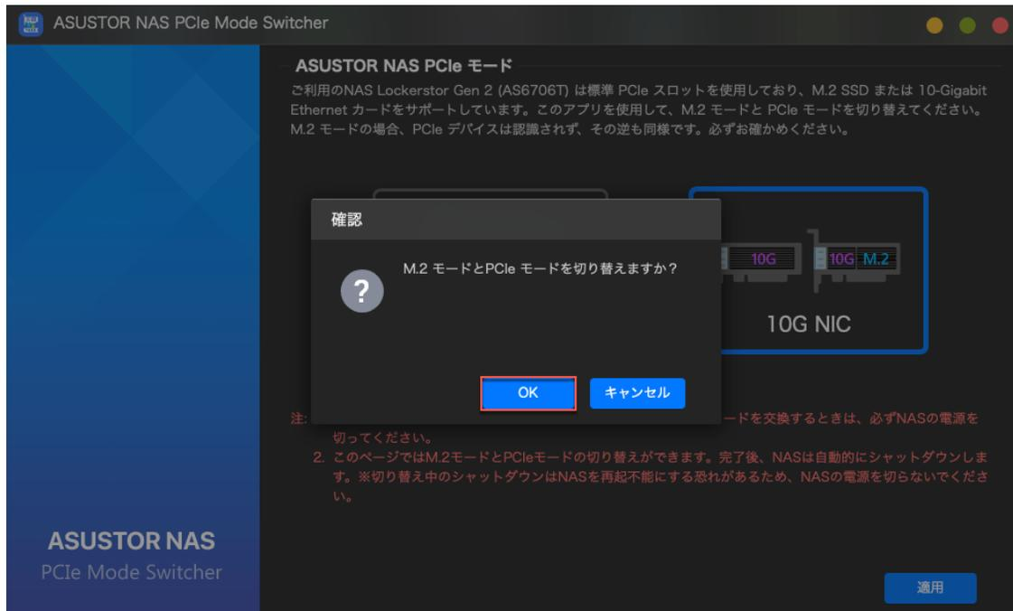
4. 確認後、NAS はシャットダウンします。シャットダウン後、NAS を主電源から取り外すと、10 ギガビットイーサネットカードをインストールすることができるようになります。
