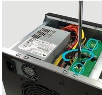
2. 下図のように、PCIe スロットから M.2 カードをゆっくりと引き抜きます。
