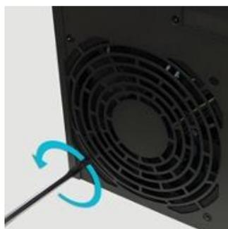
4. ファンのねじを取り外したアナにブラケットを配置します。ファンのねじを再び取り付け、ブラケットを固定します。
