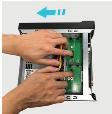
3. M.2 カード用ブラケットを固定している 2 本のネジを外してください。
