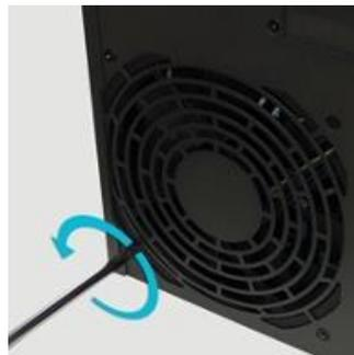
4. Positionnez le support sur le trou pour la vis enlevée du ventilateur. Fixez le support en remplaçant la vis du ventilateur.
