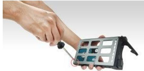
4. Extrayez le tiroir de disque de sa baie sur les rails. En utilisant le verrou, enfoncez doucement le tiroir de disque à fond dans sa baie. Fixez le tiroir de disque en place en enfonceant le verrou. Le verrou doit fermer facilement et s'enclencher avec un 'clic' audible. Veuillez vous assurer que le tiroir du disque est enfoncé à fond dans la baie du disque avant de tenter de fermer le verrou.
