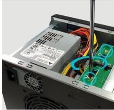
2. Extraiga suavemente la tarjeta M.2 de la ranura PCIe, como se muestra a continuación.
