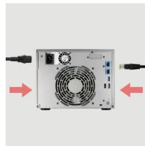
3. Mantenga pulsado el botón de encendido/apagado durante 1 ó 2 segundos hasta que el indicador LED de alimentación se encienda en azul. Esto indica que el NAS está encendido. Durante el encendido del NAS, el indicador LED de estado del sistema parpadeará en verde y el indicador LED de red se encenderá en azul.
