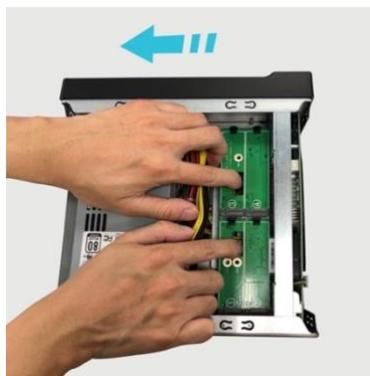
3. Lösen Sie die beiden Schrauben, mit denen die Halterung für die M.2-Karte befestigt ist.
