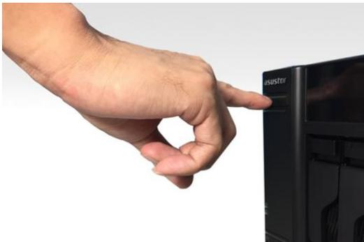
4. Der NAS ist betriebsbereit, sobald die grüne Systemstatus-LED nicht mehr blinkt, sondern dauerhaft leuchtet. Dabei sollten Sie einen Signalton hören. Die Hardwareinstallation ist nun abgeschlossen. Lesen Sie zur Konfiguration der Systemeinstellungen nun die Softwareinstallationsanleitung.
