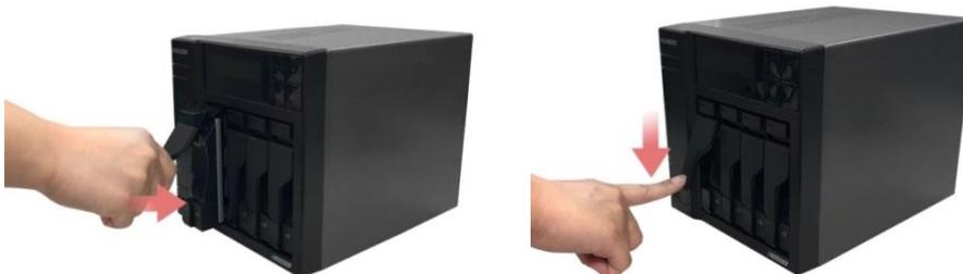
5. Sobald der Riegel befestigt ist, können Sie ihn mit Hilfe der Sperre des Datenträgerfachs verriegeln. Drehen Sie die Sperre zum Verriegeln des Mechanismus mit einem Schlitzschraubendreher gegen den Uhrzeigersinn. Durch Drehen im Uhrzeigersinn entriegeln Sie die Sperre.
