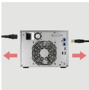
Der PCIe-Anschluss in Ihrem NAS unterstützt kein 'Hot-Swap'. Bitte schalten Sie Ihr NAS aus und ziehen Sie den Stecker, bevor Sie PCIe-Geräte austauschen.
