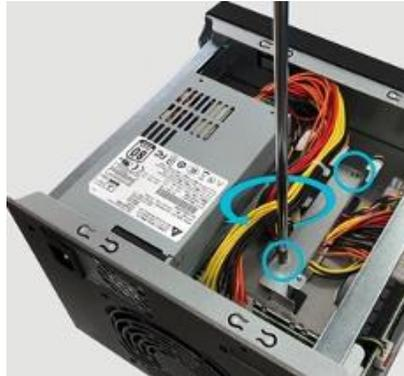
4. Heben Sie die Halterung aus dem NAS heraus.
