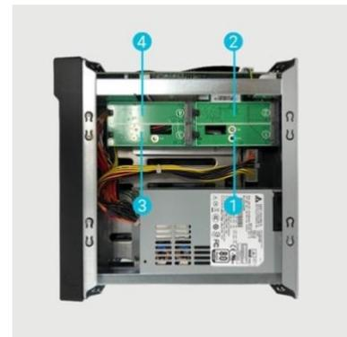
2. Setzen Sie die M.2 SSD schräg ein, richten Sie die Kerbe mit dem Anschluss aus und setzen Sie das M.2-Laufwerk ein. Vergewissern Sie sich, dass die M.2-SSD vollständig eingesetzt ist. Halten Sie den Kunststoffhebel fest und drücken Sie die M.2-SSD nach unten, bis sie im Steckplatz einrastet.
