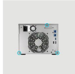
4. Greifen Sie die Abdeckung von beiden Seiten mit beiden Händen, schieben Sie sie dann zum Entfernen vom Gehäuse vorsichtig nach hinten.
