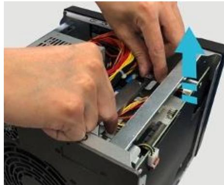
5. Entfernen Sie die beiden Schrauben an der Rückseite des NAS und der Platzhalterklammer.
