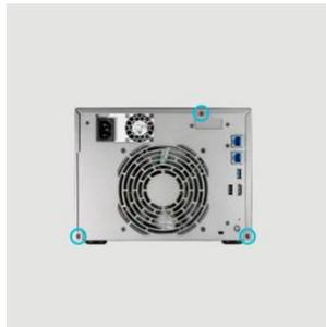
3. Greifen Sie die Abdeckung von beiden Seiten mit beiden Händen, schieben Sie sie dann zum Entfernen vom Gehäuse vorsichtig nach hinten.
