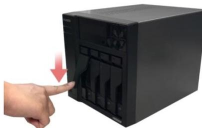
5. Une fois le loquet fixé, vous pouvez le verrouiller avec le verrou du plateau de disque. Avec un tournevis à tête plate, tournez le verrou dans le sens horaire inversé pour verrouiller le mécanisme du loquet. Tournez le verrou dans le sens horaire pour le déverrouiller.
