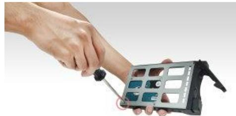
4. Extrayez le tiroir de disque de sa baie sur les rails. En utilisant le verrou, enfoncez doucement le tiroir de disque à fond dans sa baie. Fixez le tiroir de disque en place en enfonçant le verrou. Le verrou doit fermer facilement et s'enclencher avec un 'clac' audible. Veuillez vous assurer que le tiroir du disque est enfoncé à fond dans la baie du disque avant de tenter de fermer le verrou.
