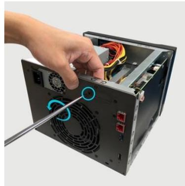
6. Dévissez et retirez le support pleine hauteur du AS-T10G2 NIC. L'installation de l'[AS-T10G2](#) nécessite l'utilisation du support inclus conçu pour la série d'appareils NAS Lockerstor Gen2.
