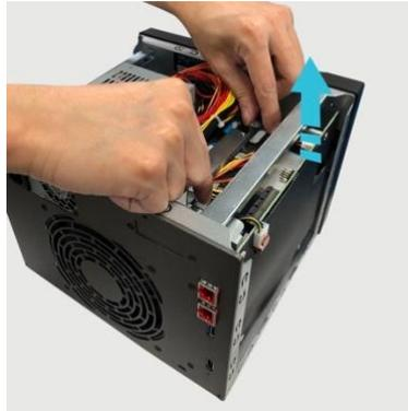
5. Retirez les deux vis à l'arrière du NAS et le support d'espace réservé.
