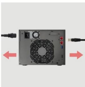
**Le socket PCIe à l'intérieur de votre NAS ne prend pas en charge la fonctionnalité d'échange à chaud. Veuillez éteindre et débrancher votre NAS avant de changer de périphérique PCIe.**
