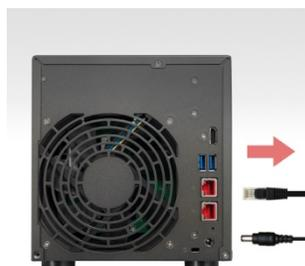
3. Utilizzare un cacciavite per allentare le tre viti sulla parte posteriore del NAS, come mostrato nell'illustrazione.
