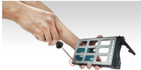
4. Far scorrere il vassoio del disco sui binari dell'alloggiamento del disco. Usando il blocco, estrarre con attenzione il vassoio del disco dal suo alloggiamento. Fissare il vassoio del disco in posizione spingendo verso il basso il blocco. Il blocco deve chiudersi senza problemi con uno scatto che deve essere percepibile. Assicurarsi di aver spinto il vassoio del disco per tutta la corsa nell'alloggiamento del disco prima di provare a chiudere il blocco.
