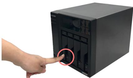
2. Usando il blocco, estrarre con attenzione il vassoio del disco dal suo alloggiamento.
