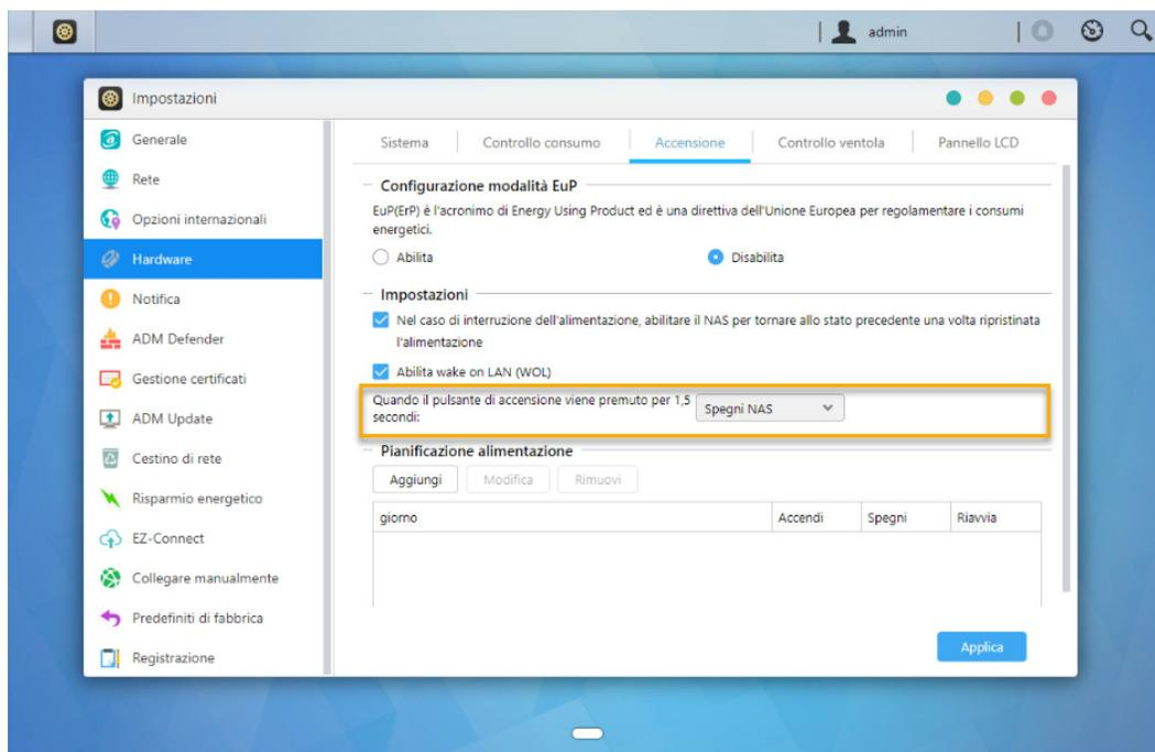
2. Tenete premuto il pulsante di accensione per 1,5 secondi. Una volta fatta questa semplice operazione, dovrete essere in grado di sentire un "beep" proveniente dal sistema acustico. A questo punto, lasciate andare il pulsante e a seconda del tipo di settaggio da voi configurato, il NAS si chiuderà o entrerà in modalità "riposo".
