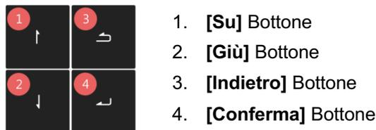
Dopo l'accensione del NAS, sarà possibile vedere sul pannello LCD, il nome del modello e l'indirizzo IP. Il pannello si spegne automaticamente dopo alcuni secondi. È possibile utilizzare il pannello per configurare le impostazioni e controllare le informazioni di sistema.
