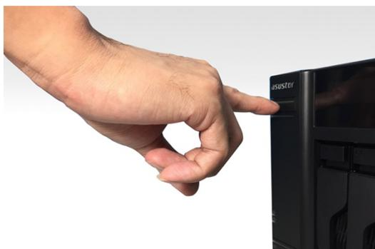
4. Il NAS è pronto all'uso quando il LED verde dello stato del sistema smette di lampeggiare e rimane acceso. A questo punto dovrebbe anche sentirsi un 'bip' dal cicalino del sistema. L'installazione dell'hardware è così completa. Passare quindi alla guida per l'installazione del software per configurare le impostazioni di sistema.
