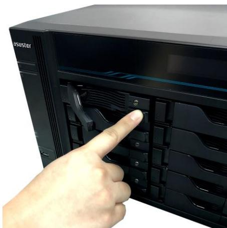
2. С помощью фиксатора осторожно вытяните лоток для диска из дискового отсека.
