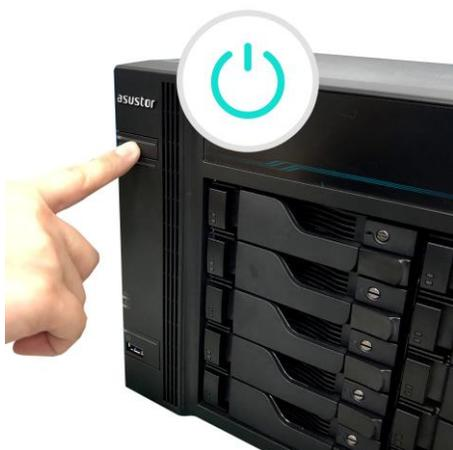
4. Устройство NAS готово к работе после того, как зеленый индикатор состояния системы перестает мигать и горит постоянно. В этот момент подается звуковой сигнал зуммера системы. После этого установка оборудования будет завершена. Теперь для настройки системы обратитесь к руководству по установке программного обеспечения.
