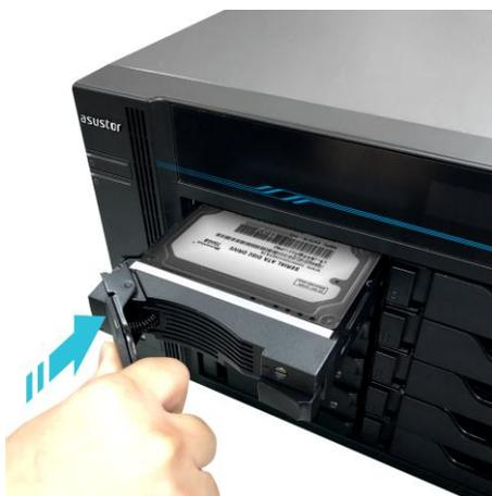
5. Закрепленную защелку можно заблокировать фиксатором лотка для дисков. Возьмите отвертку с плоской головкой и поверните фиксатор против часовой стрелки, чтобы заблокировать механизм защелки. Чтобы разблокировать механизм, поверните фиксатор по часовой стрелке.
