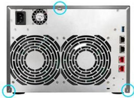
8. Возьмитесь за крышку двумя руками и осторожно сдвиньте ее назад и снимите с системного блока.
