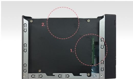
2. Dra tillbaka det svarta skyddshöljet på båda minnesmodulerna. Lossa ejektorklämmorna genom att försiktigt dra ut dem åt sidorna, och ta därefter ut den inbyggda minnesmodulen.
