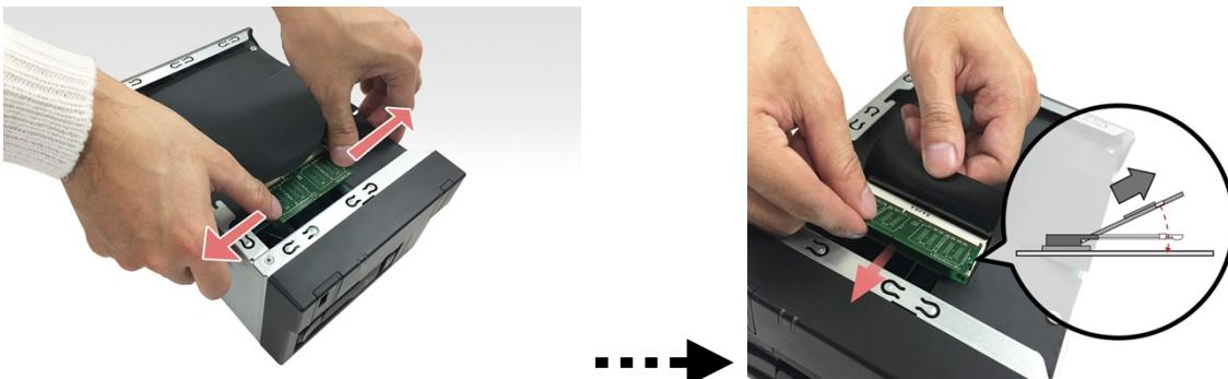
3. Installera den nya minnesmodulen i öppning nr. 1. Förläng minnesmodulen diagonalt (se bilden) så att minnesmodulens kontakter är riktigt insatta i facket. Tryck försiktigt minnesmodulen ner och tillbaka med två fingrar, tills den klickar på plats. Du ska kunna höra "klick"-ljudet.
