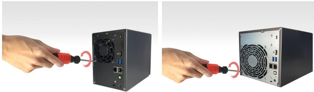
4. Placera fästet över hålet för den borttagna fläktskruven. Fäst konsolen på plats genom att ersätta fläktskruven.
