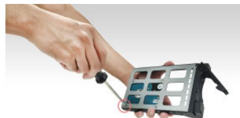
4. För på brickan på skenorna i diskfacket. Tryck med hjälp av haken försiktigt in brickan helt i facket. Fäst brickan på plats genom att trycka haken nedåt. Haken ska stängas lätt och knäppa igen med ett hörbart 'klick'. Kontrollera att brickan är helt intryckt i facket innan haken låses på plats.
