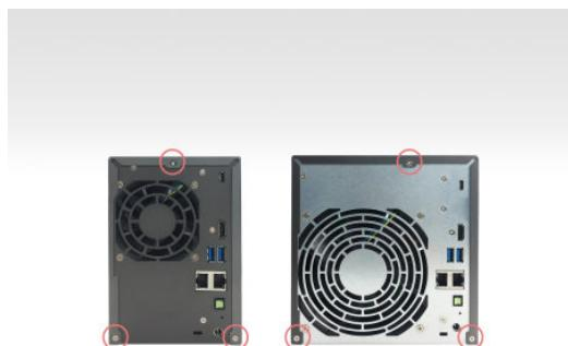
4. Ta tag om höljet med båda händerna från två sidor, och skjut det försiktigt bakåt för att ta bort från chassiet.
