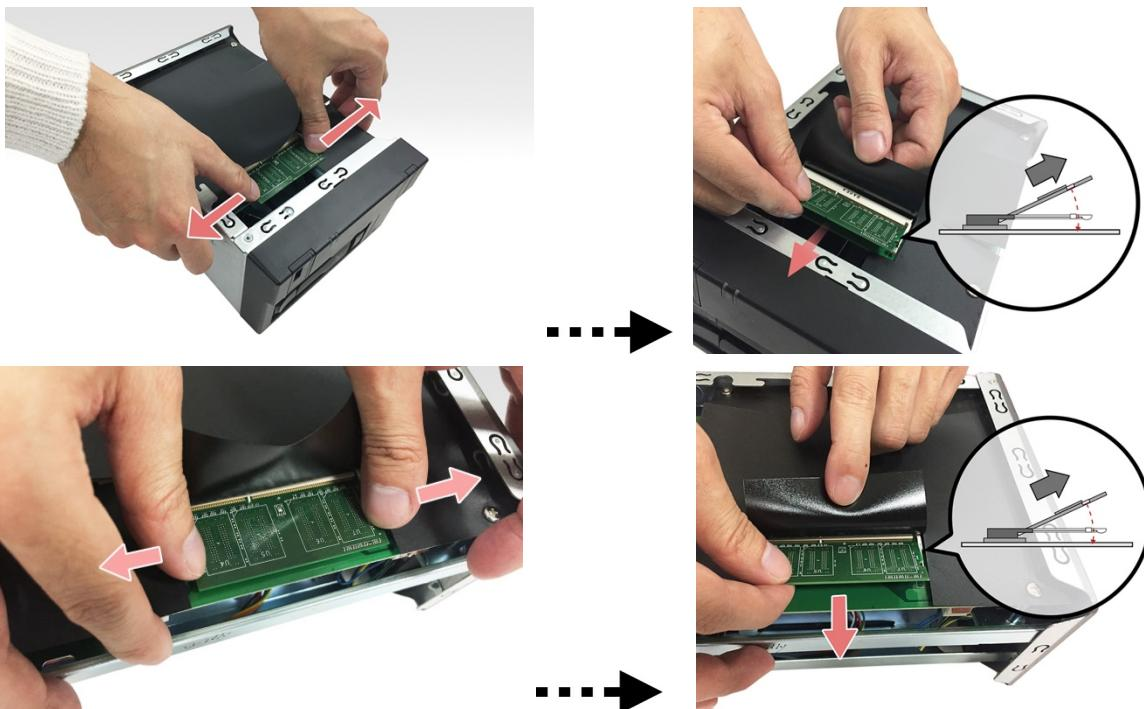
3. Installera de nya minnesmodulerna i öppning nr. 1 och nr. 2. Förlägg minnesmodulens kontakter diagonalt (se bilden) så att minnesmodulens kontakter är riktigt insatta i facket. Tryck försiktigt minnesmodulerna och tillbaka med två fingrar, tills den klickar på plats. Du ska kunna höra "klick"-ljudet.
