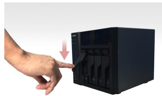
5. När haken är säkrad kan du låsa den på plats med hjälp av diskbrickans lås. Using a flathead screwdriver, turn the lock counterclockwise to lock the latch mechanism. Vrid låset moturs med en platt skravmejsel för att låsa hakmekanismen. Turning the lock clockwise will unlock it. Genom att vrinda låset medurs låses hakmekanismen upp.
