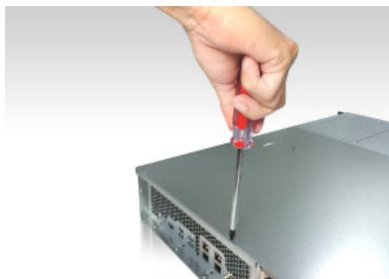
4. Ta tag om höljet med båda händerna från två sidor, och skjut det försiktigt bakåt för att ta bort från chassiet.
