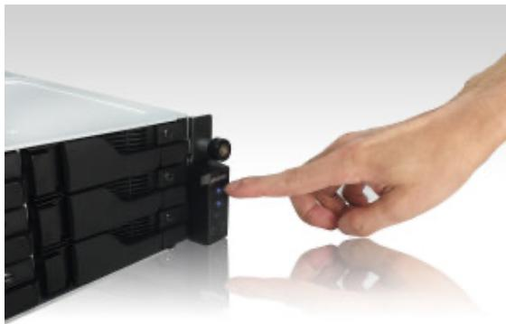
4. NAS-enheten är klar för användning när systemets gröna statusindikationslampa slutar blinka, och lyser med fast ljus. Då ska det även höras ett pipande ljud från systemets summer. Nu är maskinvaruinstallationen klar. Gå över till installationsguiden för programvaran för att konfigurera systeminställningarna.
