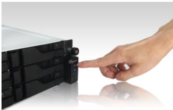
4. El NAS estará listo para usarse una vez que el indicador LED verde de estado del sistema deje de parpadear y se estabilice. El zumbador del sistema también emitirá una señal sonora. La instalación de hardware ha finalizado. Consulte la guía de instalación de software para configurar los ajustes del sistema.
