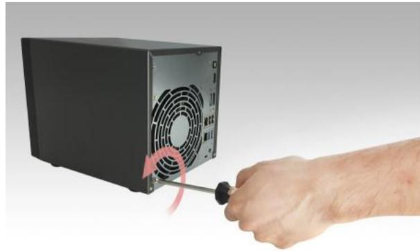
4. ファンのねじを取り外したアナにブラケットを配置します。ファンのねじを再び取り付け、ブラケットを固定します。
