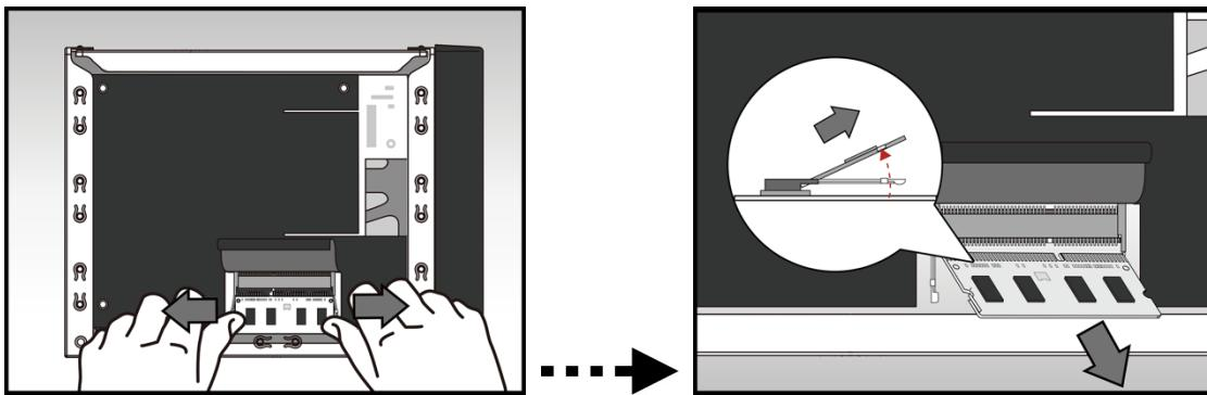
3. 安裝至系統預載的卡扣上，斜放記憶體，並將記憶體金屬接點完全推入插槽。兩隻手指平均施力，壓下記憶體模組，當記憶體進入正確位置後，會發出一聲“喀答”。
