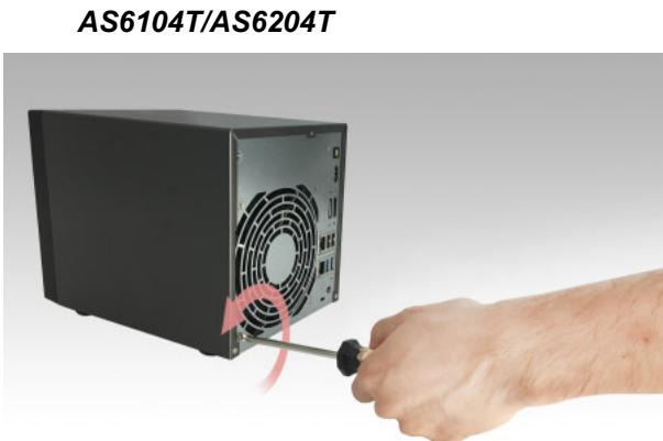
4. 將扣環鎖到風扇螺絲孔的位置, 依箭頭方向鎖緊。
