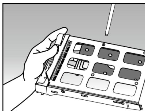
4. 握住硬碟托盤把手上方，將托盤沿著硬碟安裝槽推到底，然後下壓把手以固定硬碟托盤。當把手固定時，您會聽到一聲“喀答”。
