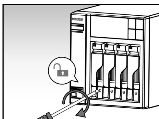
註: AS62 系列適用於有鎖的硬碟托盤。
