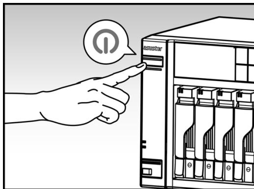
4. 當您看到綠色系統指示燈恆亮並聽到一聲”嗶”時，表示 NAS 系統已就緒。至此系統開機程序已完成，請參閱軟體安裝指南進行系統設定。
