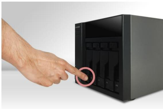
2. Usando il blocco, estrarre con attenzione il vassoio del disco dal suo alloggiamento.
