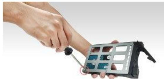
4. Far scorrere il vassoio del disco sui binari dell'alloggiamento del disco. Usando il blocco, estrarre con attenzione il vassoio del disco dal suo alloggiamento. Fissare il vassoio del disco in posizione spingendo verso il basso il blocco. Il blocco deve chiudersi senza problemi con uno scatto che deve essere percepibile. Assicurarsi di aver spinto il vassoio del disco per tutta la corsa nell'alloggiamento del disco prima di provare a chiudere il blocco.
