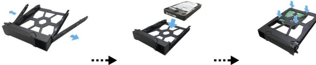
4. Extrayez le tiroir de disque de sa baie sur les rails. En utilisant le verrou, enfoncez doucement le tiroir de disque à fond dans sa baie. Fixez le tiroir de disque en place en enfonceant le verrou. Le verrou doit fermer facilement et s'enclencher avec un 'clac' audible. Veuillez vous assurer que le tiroir du disque est enfoncé à fond dans la baie du disque avant de tenter de fermer le verrou.
