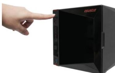
4. Le NAS est prêt à fonctionner une fois que le voyant LED vert d'état du système cesse de clignoter et reste allumé. À ce moment, vous devriez aussi entendre un 'bip' au niveau du buzzer du système. L'installation du matériel est maintenant terminée. Veuillez aller dans le guide d'installation du logiciel pour configurer les paramètres de votre système.
