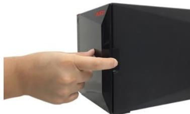
2. 依箭頭方向，將要安裝硬碟的托盤拉取出來，如下圖所示。
