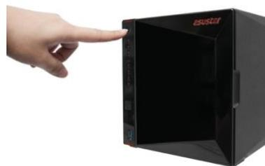
4. 當您看到綠色系統指示燈恆亮並聽到一聲“嗶”時，表示 NAS 系統已就緒。至此系統開機程序已完成，請參閱軟體安裝指南進行系統設定。
