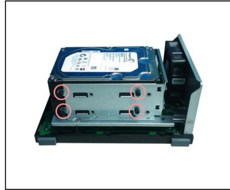
Примечание: Если Вы планируете воспользоваться функцией RAID, то мы рекомендуем использовать HDD одинаковой емкости, чтобы получить доступ ко всему объему жестких дисков.
